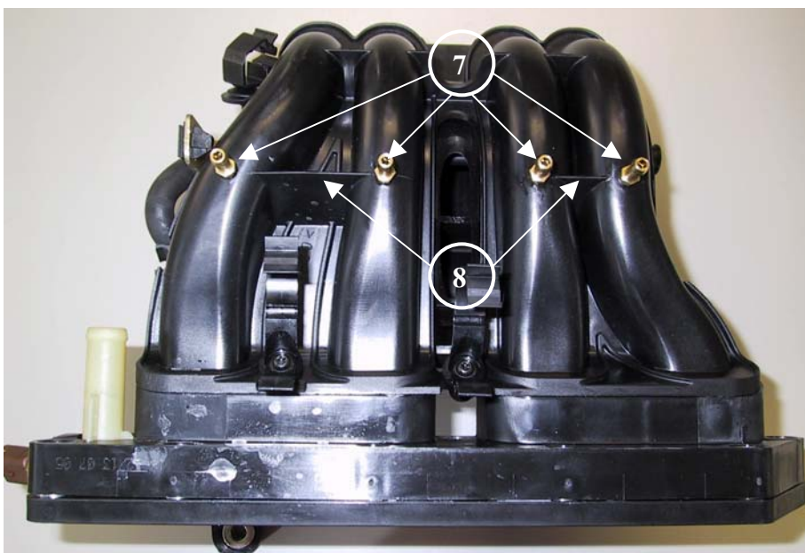
Gruppo collettori. Posizione di inserimento raccordi di iniezione del gas vedi n° 7. Il collettore è stato forato nella parte inferiore. I quattro raccordi sono tutti allineati alle paratie di rinforzo del collettore vedi n° 8.
