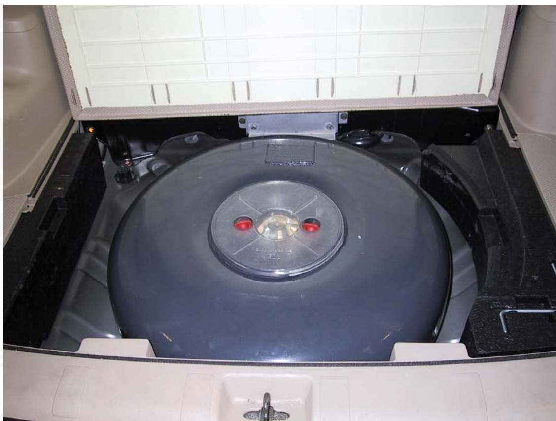
Installazione del serbatoio del gas
