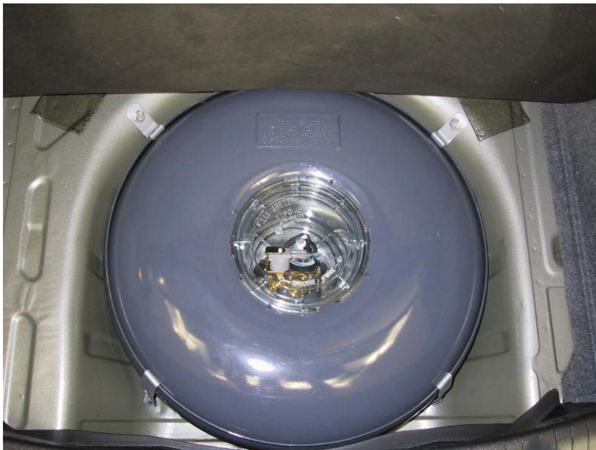
Installazione serbatoio del gas
