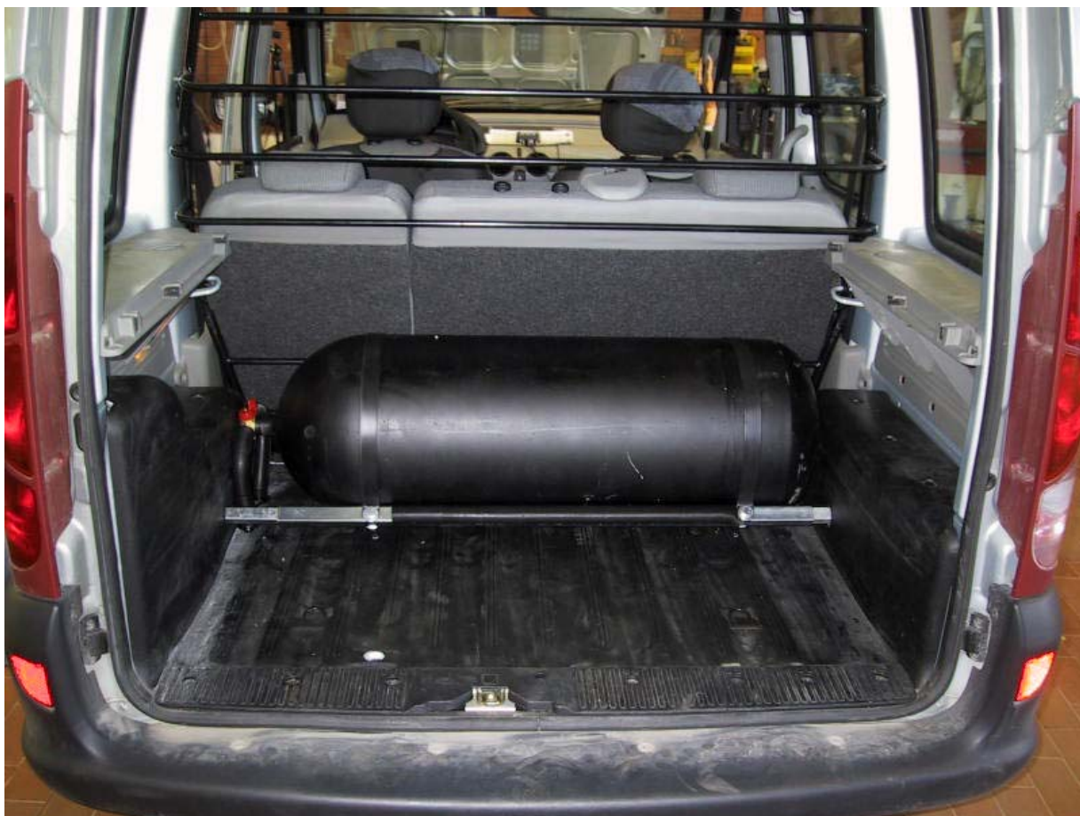
Installazione della bombola metano
