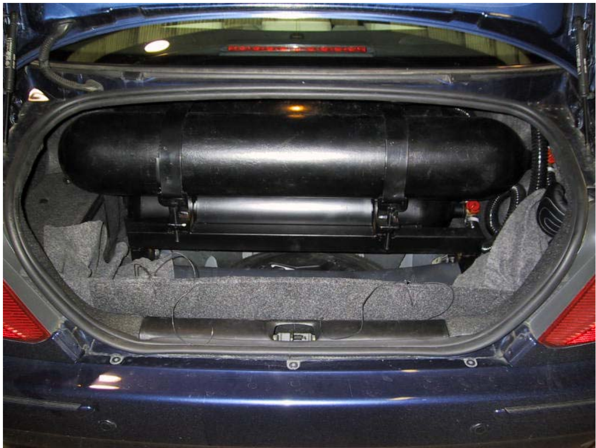
Installazione bombole metano.
