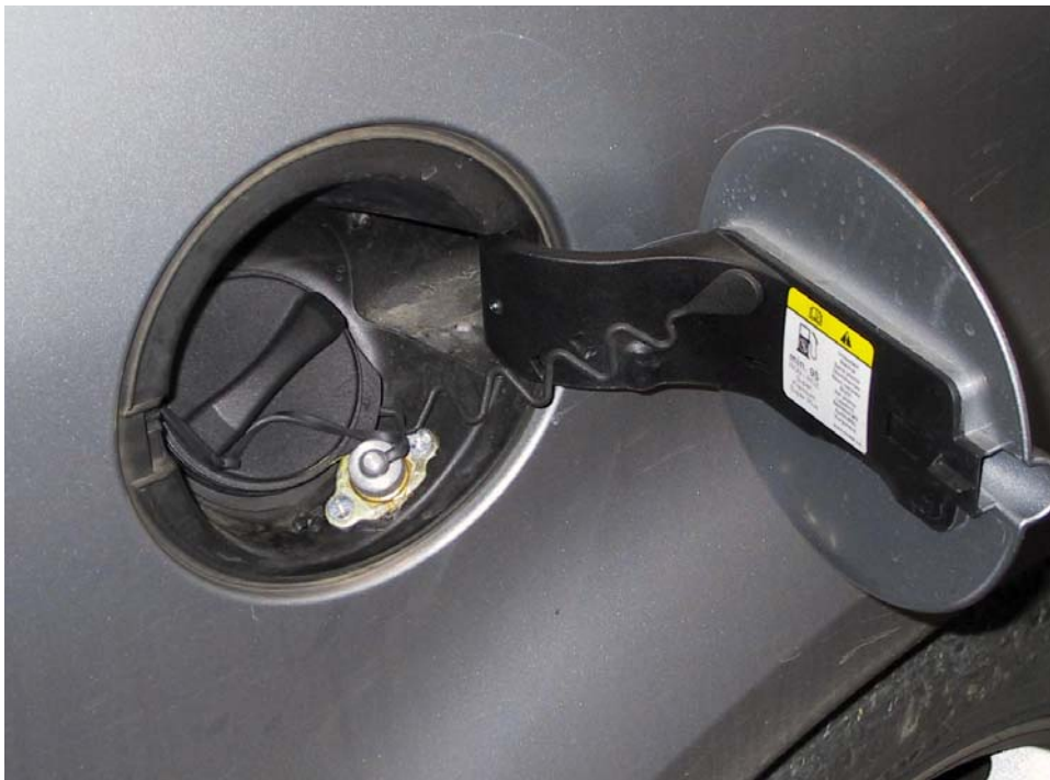
Posizione della valvola di carica del gas
