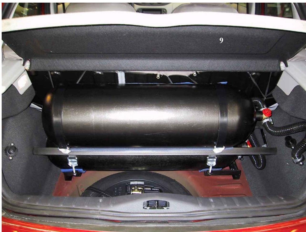
Installazione delle bombole metano
