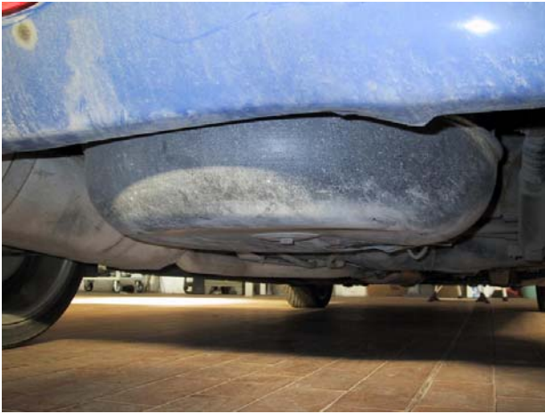
Installazione del serbatoio gpl
