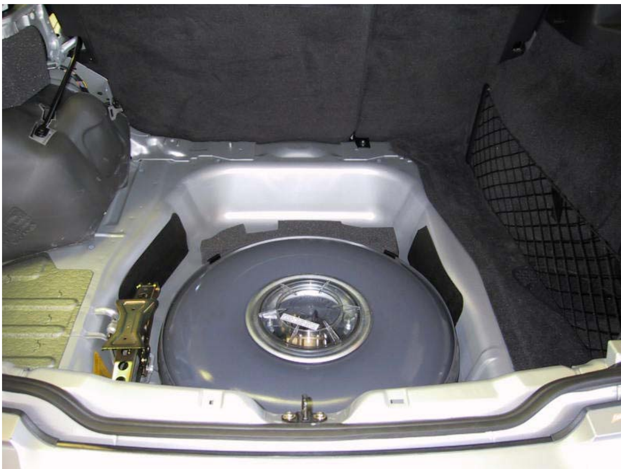
Installazione del serbatoio gpl
