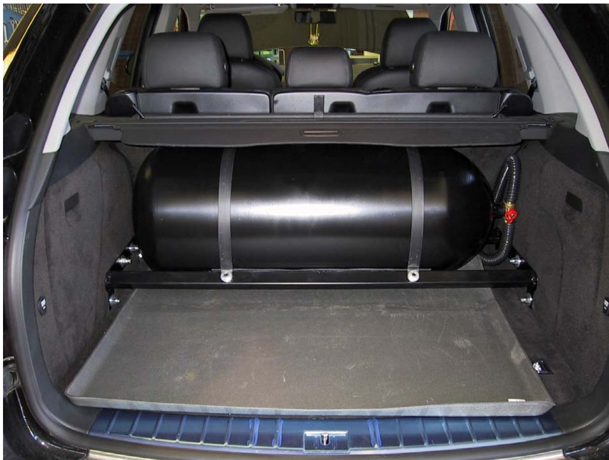
Installazione bombola metano.
