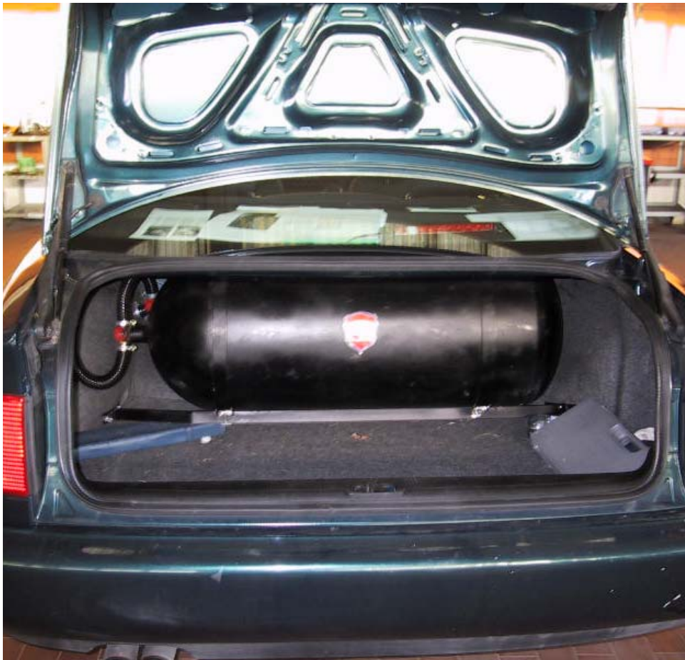
Installazione bombole metano.
