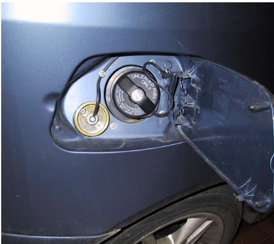
Posizione valvola di carica del gas
