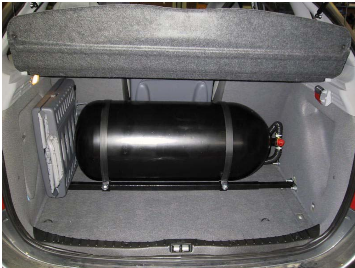
Installazione bombola metano.
