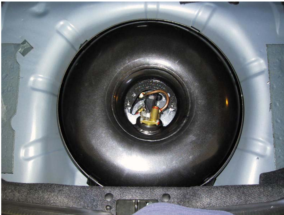
Installazione del serbatoio del gas
