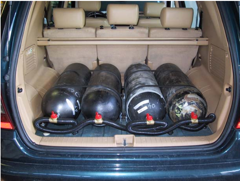
Installazione delle bombole metano
