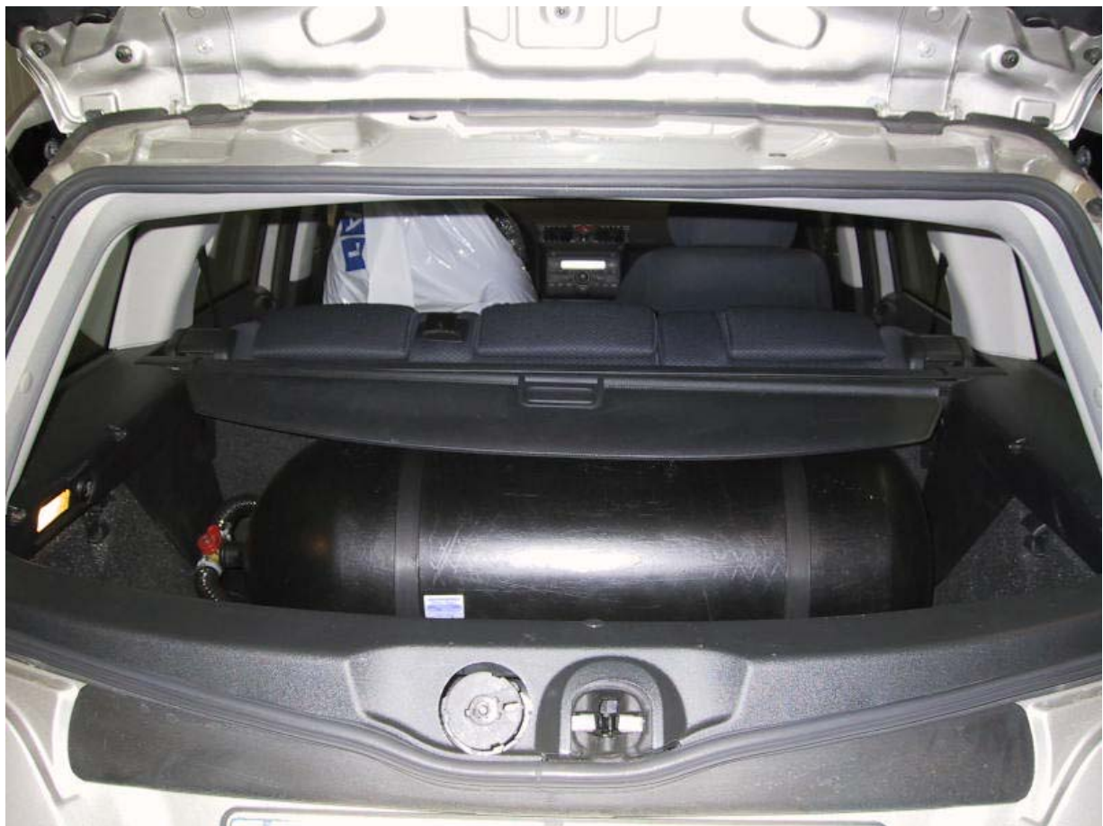
Installazione bombole metano.
