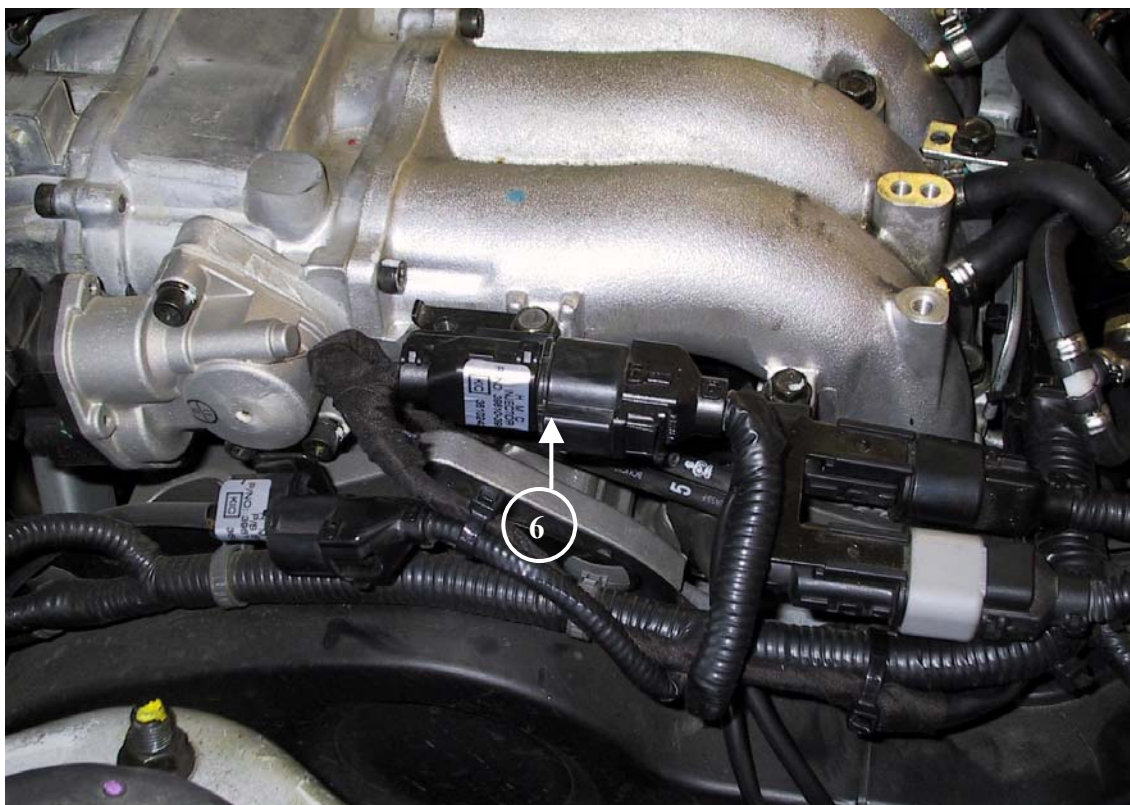
6) Connettore dei 3 iniettori benzina della prima bancata (rivolta verso l'abitacolo)
