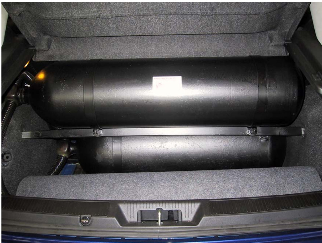
Installazione delle bombole del gas
