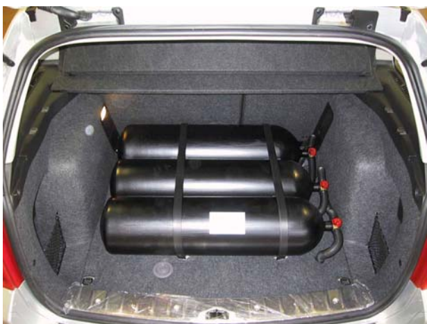
Installazione delle bombole metano
