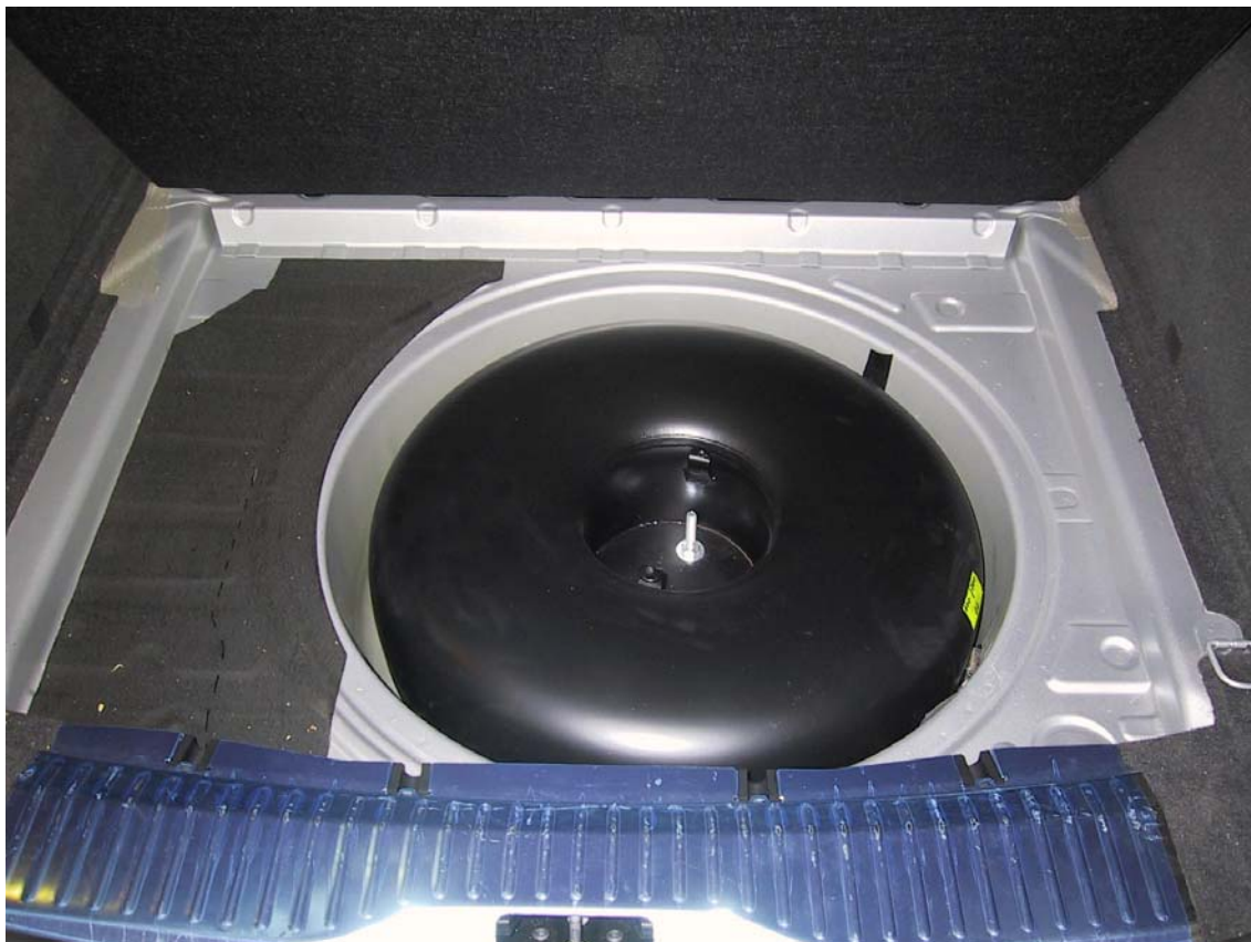
Installazione del serbatoio del gas
