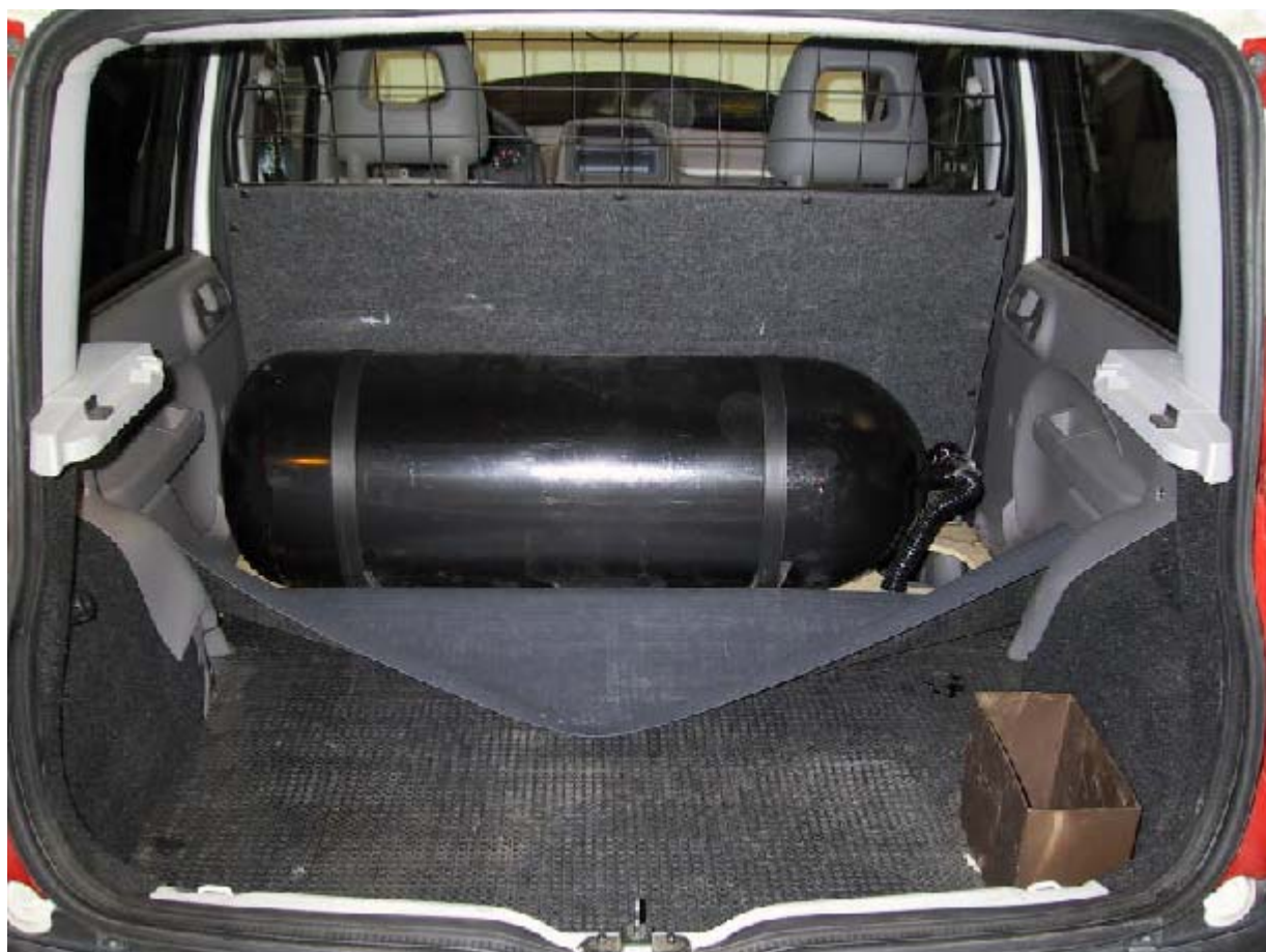
Installazione bombola metano
