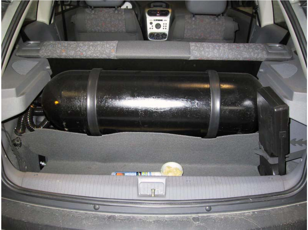
Installazione bombole metano.
