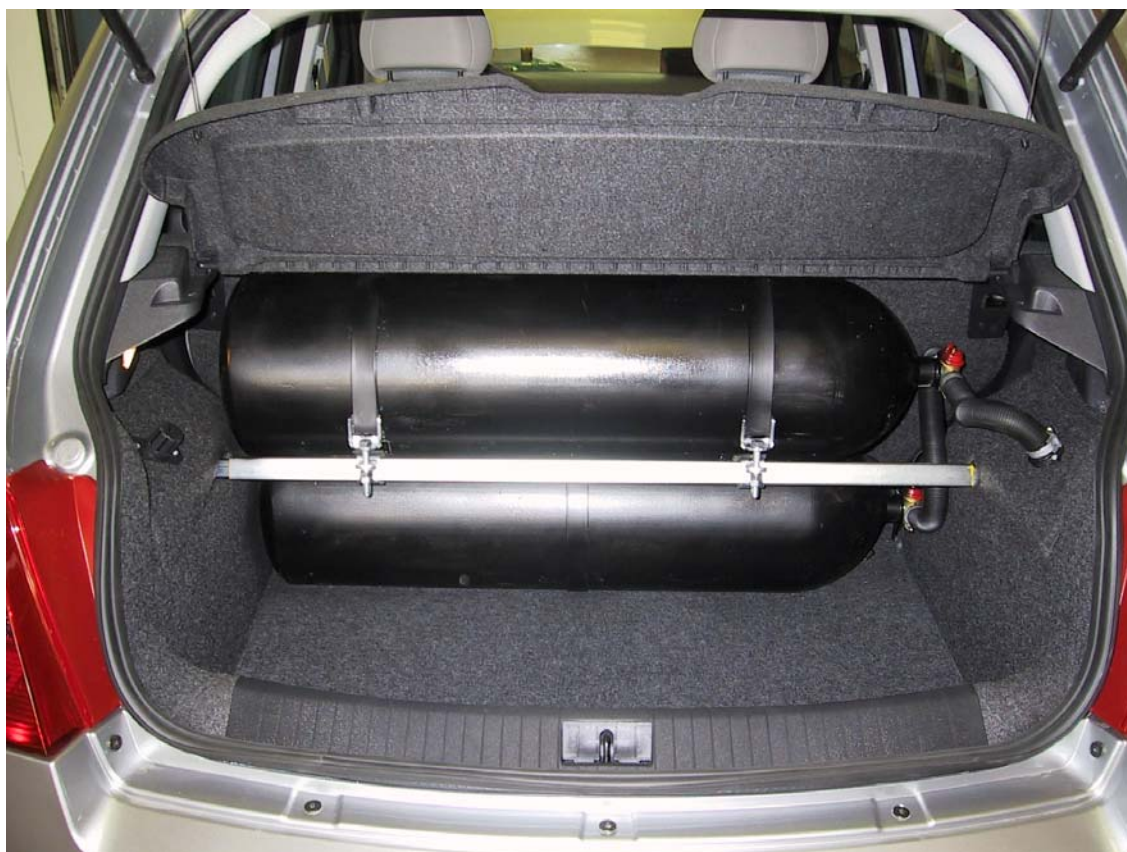
Installazione delle bombole per metano.
