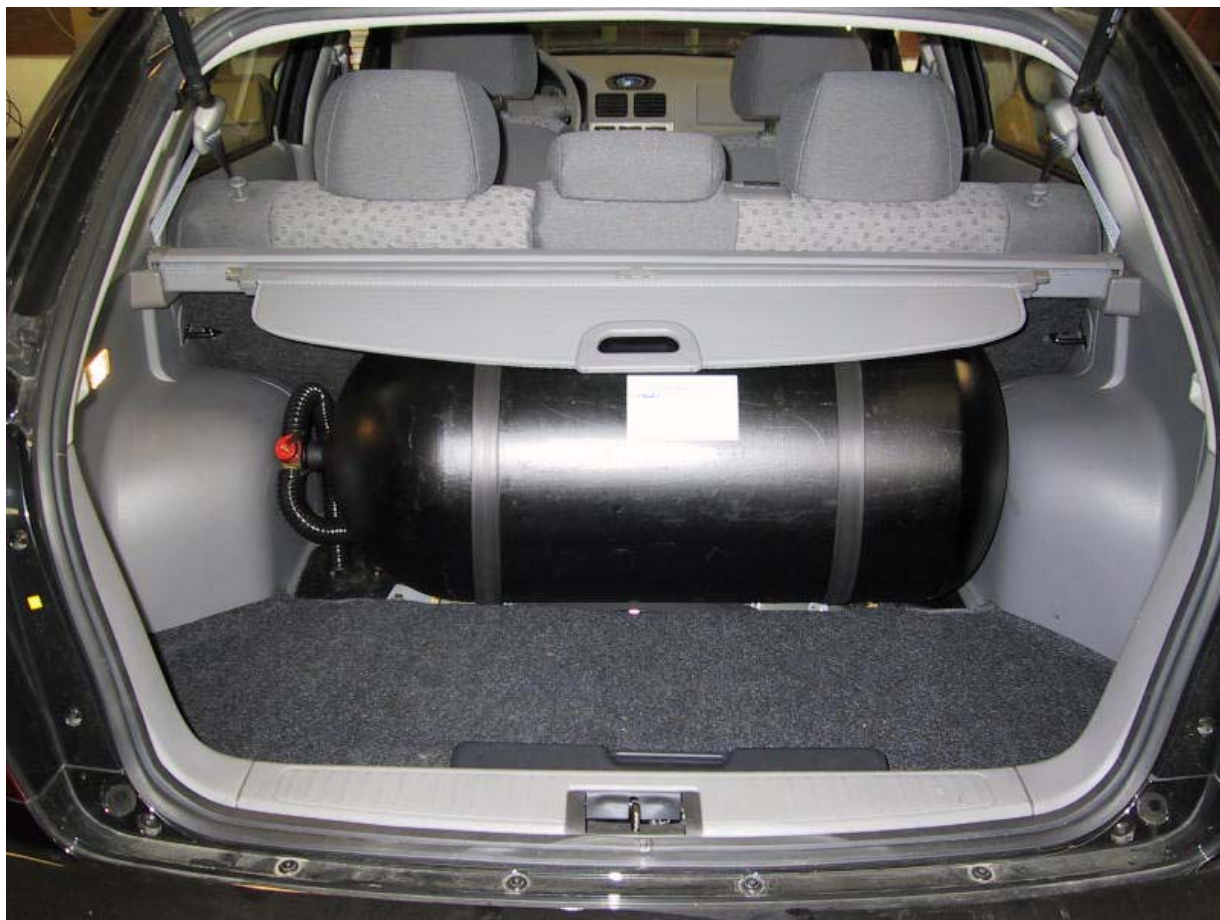
Installazione bombola metano.
