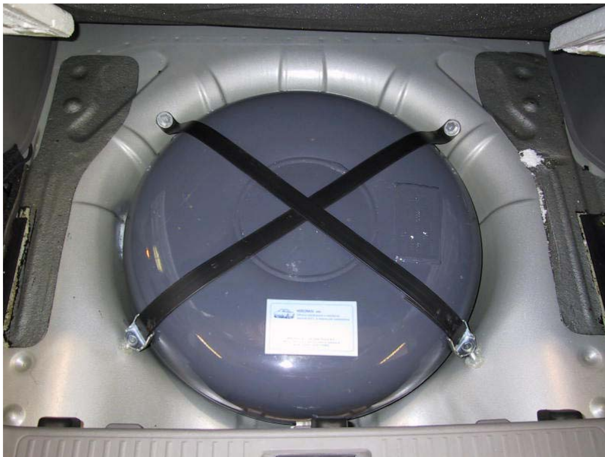
Installazione serbatoio gpl
