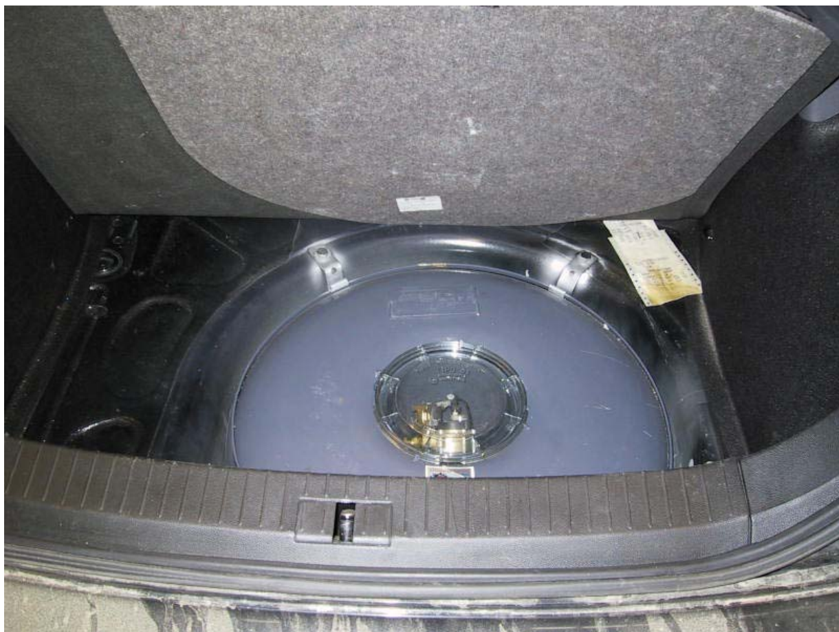
Installazione serbatoio gpl
