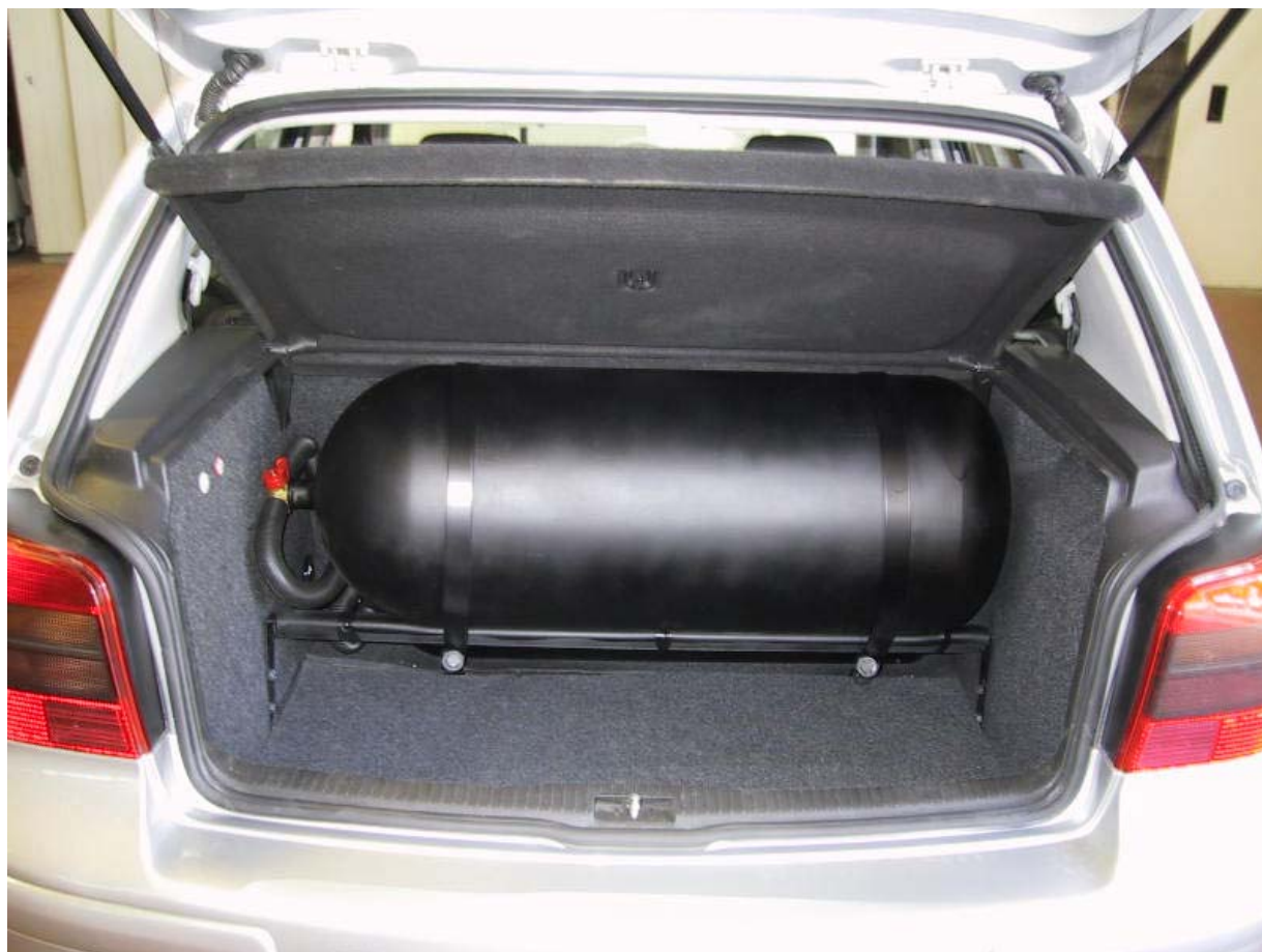
Installazione bombole metano
