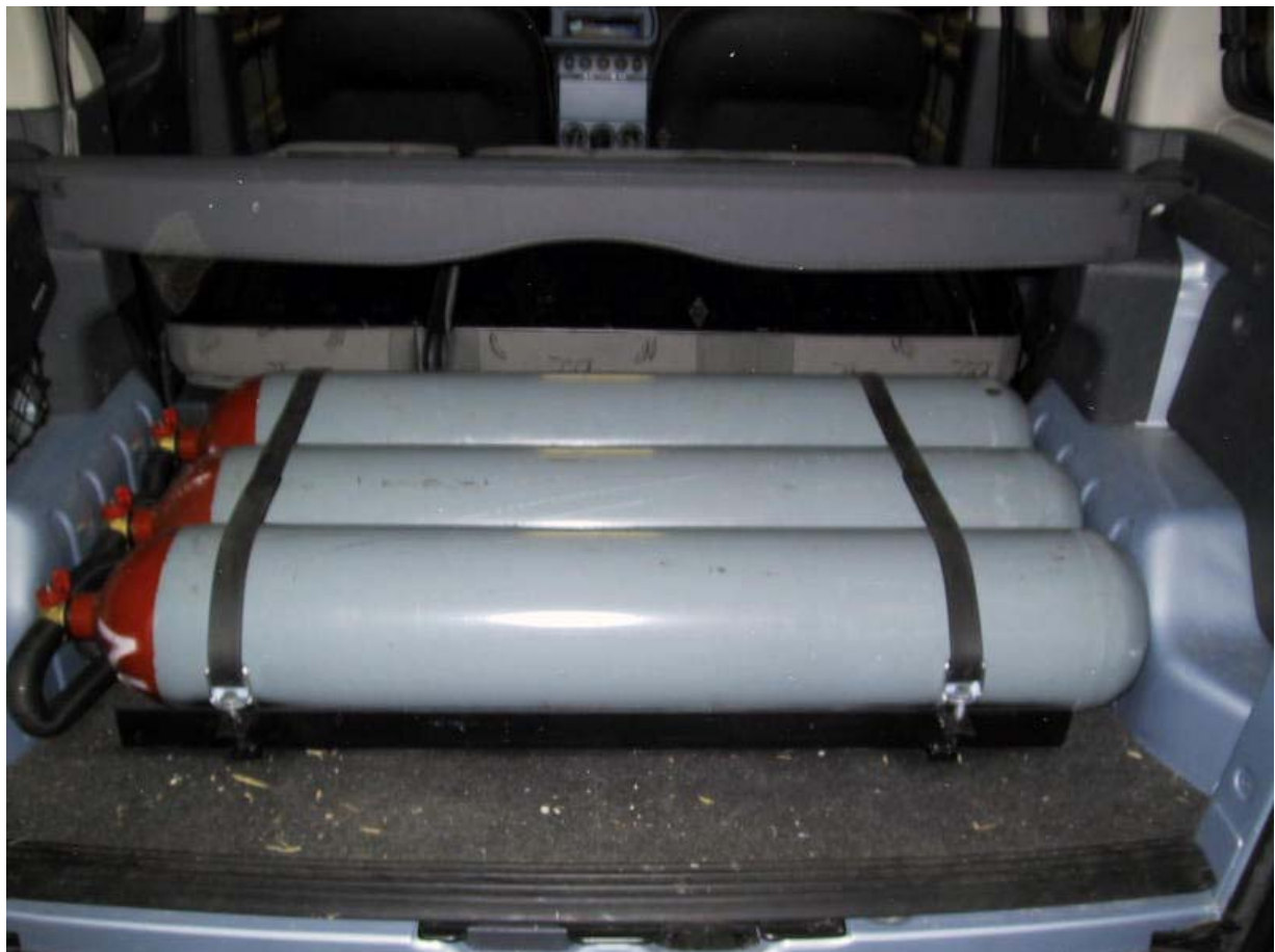
Installazione bombole metano.
