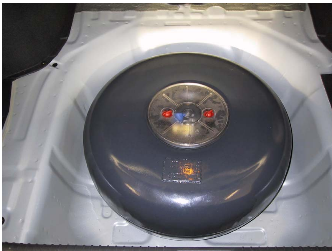
Installazione del serbatoio del gas
