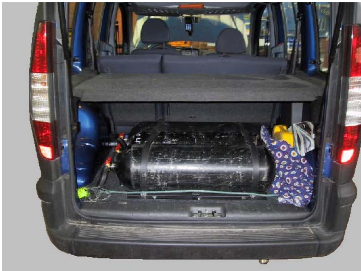
Installazione bombole metano.
