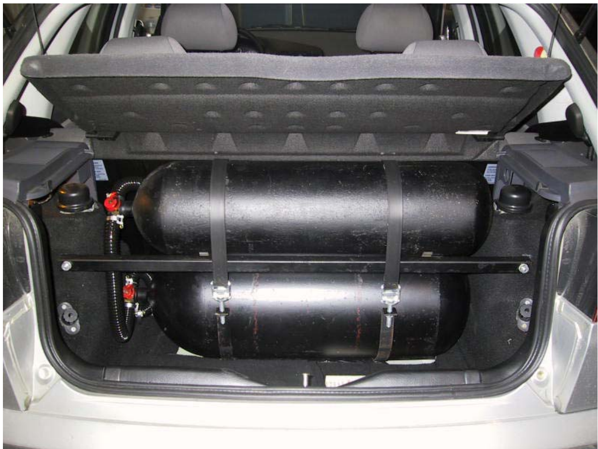
Installazione bombole metano.
