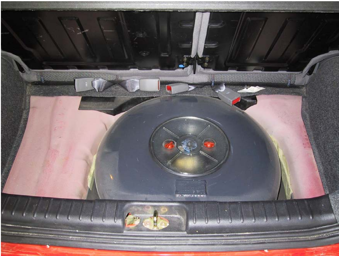
Installazione del serbatoio del gas
