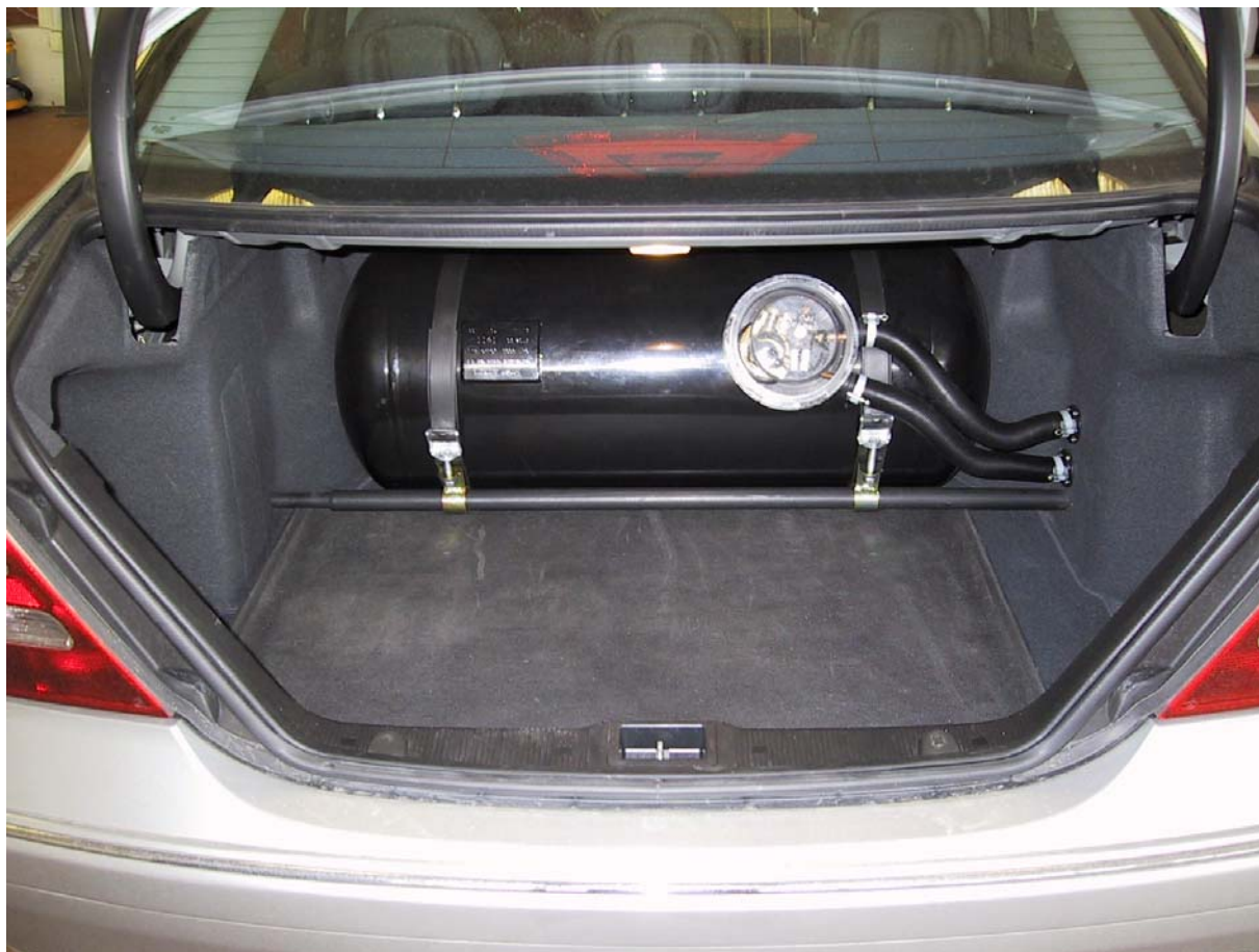
Installazione del serbatoio gpl
