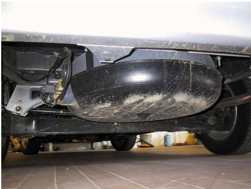
Installazione serbatoio del gas
