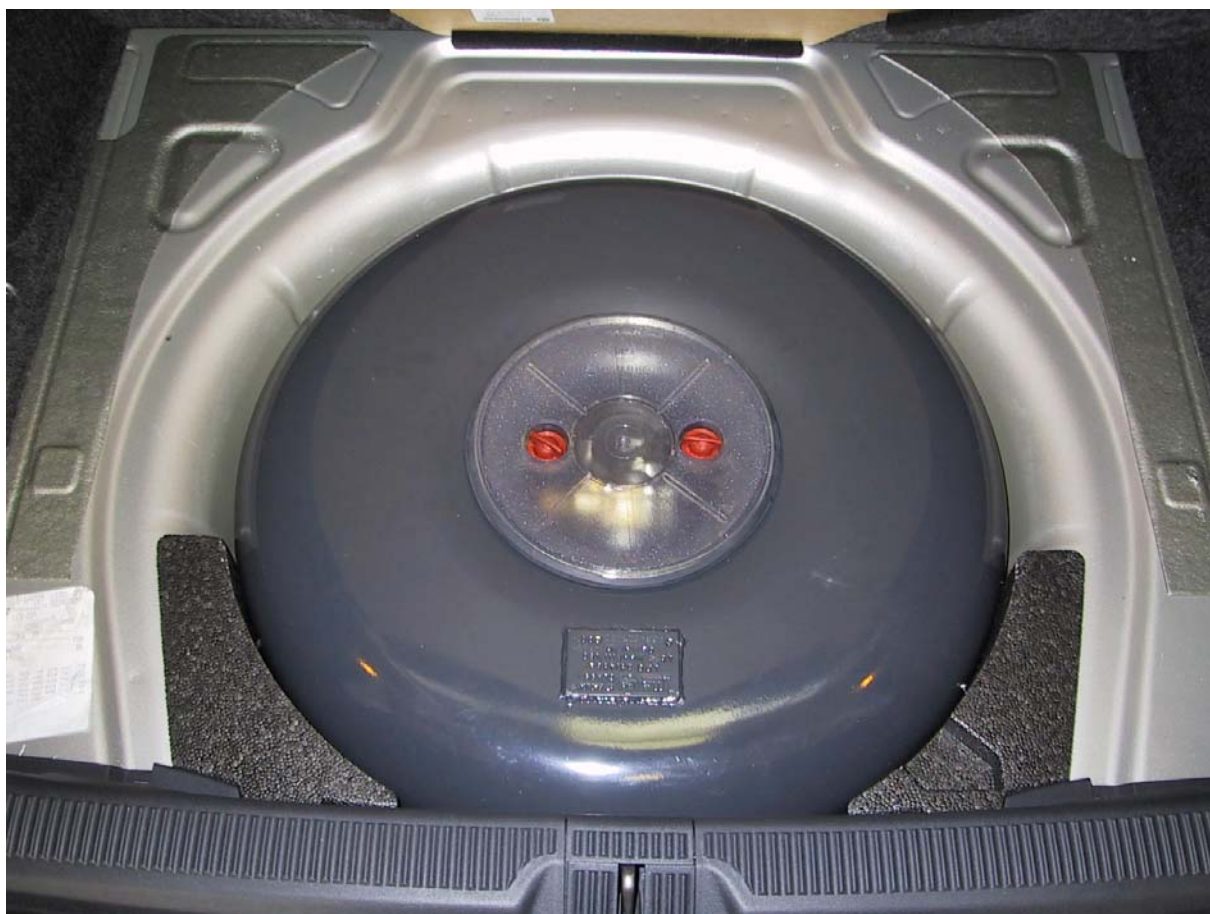
Installazione del serbatoio gpl
