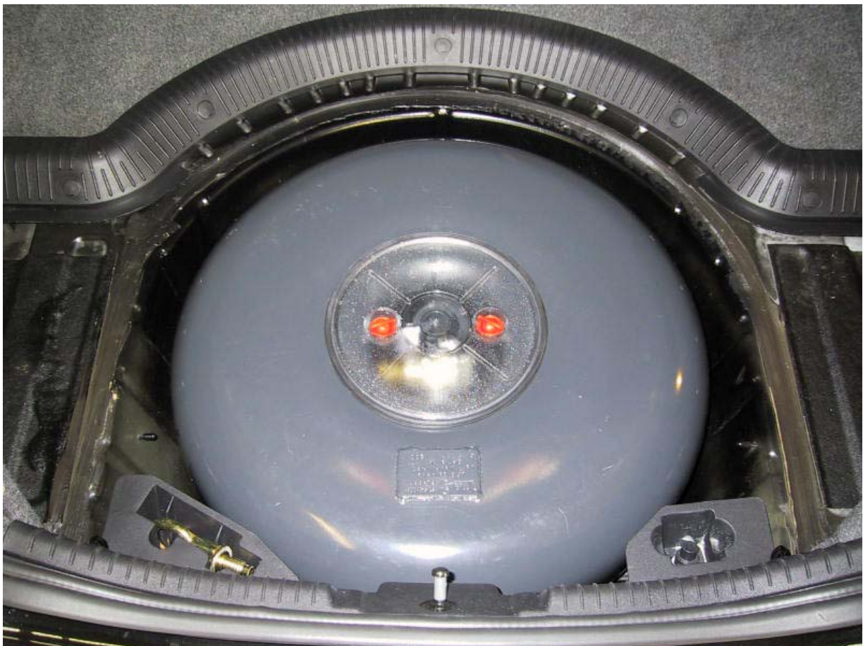
Installazione del serbatoio gpl
