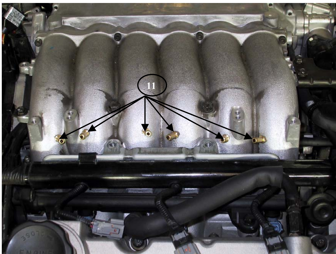
11) Posizione raccordi del gas sul collettore di aspirazione
