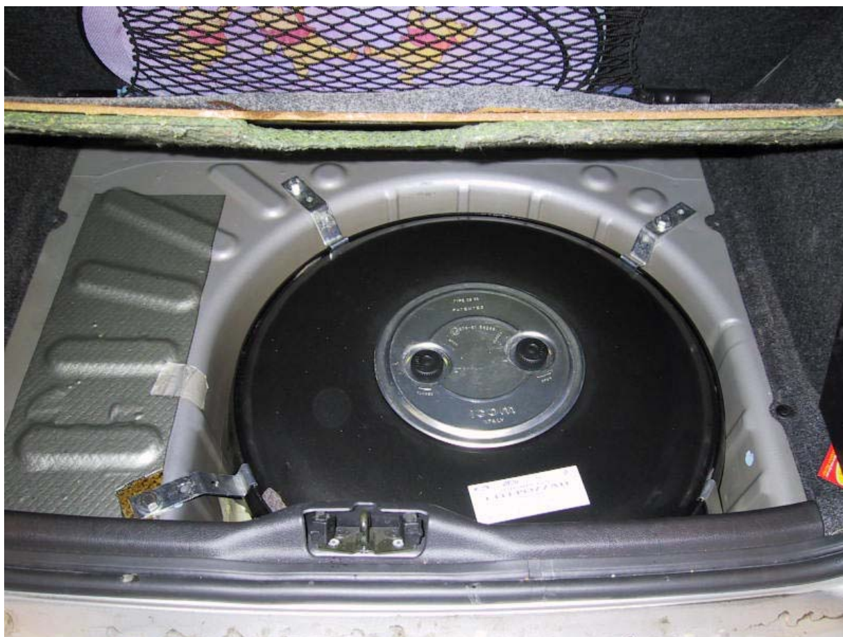
Installazione del serbatoio gpl
