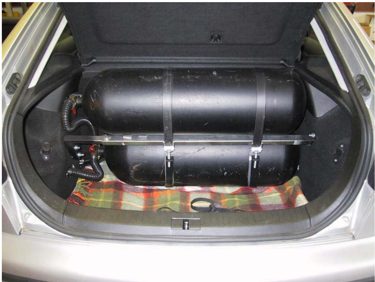
Installazione bombole metano.
