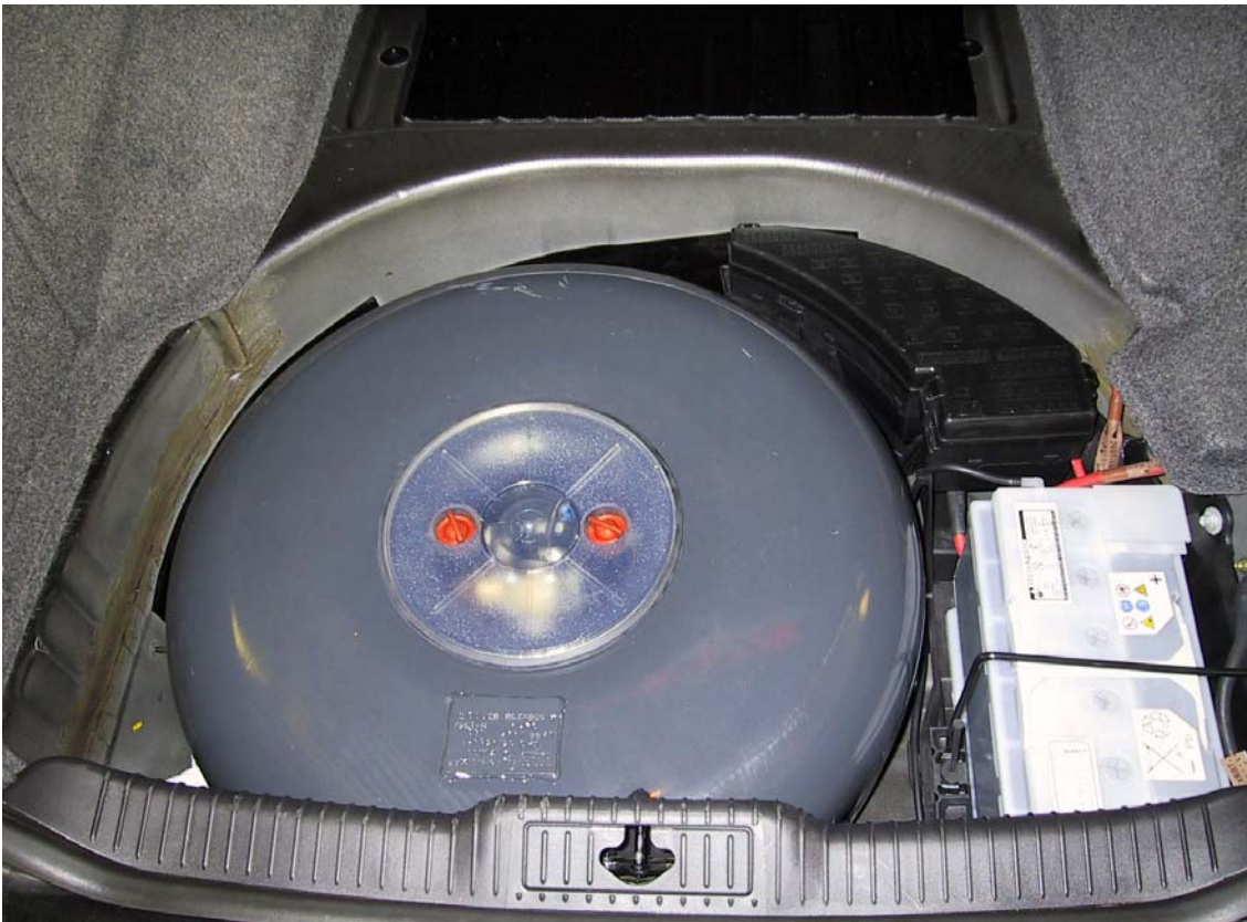
Installazione serbatoio del gas
