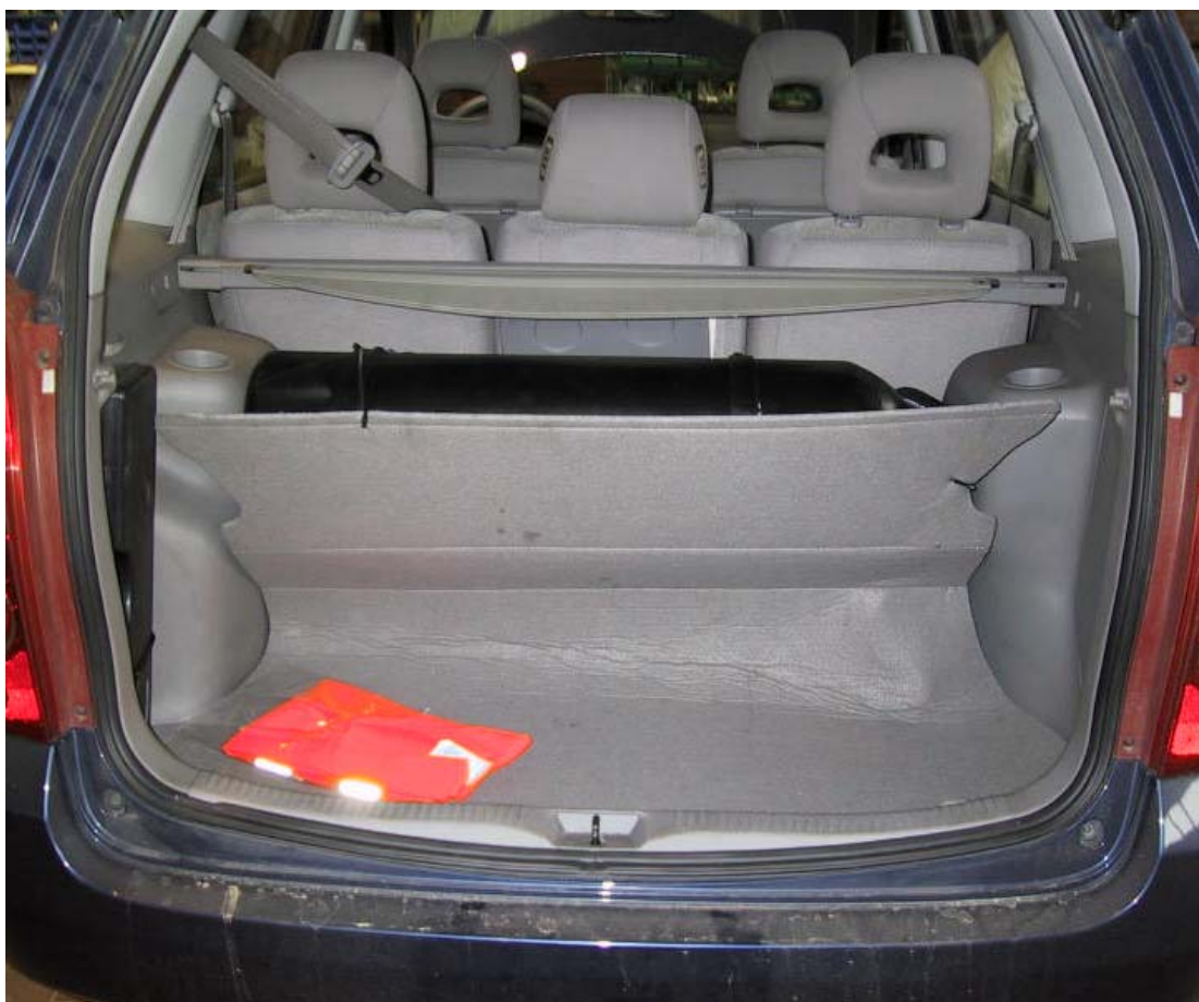
Installazione bombole metano.
