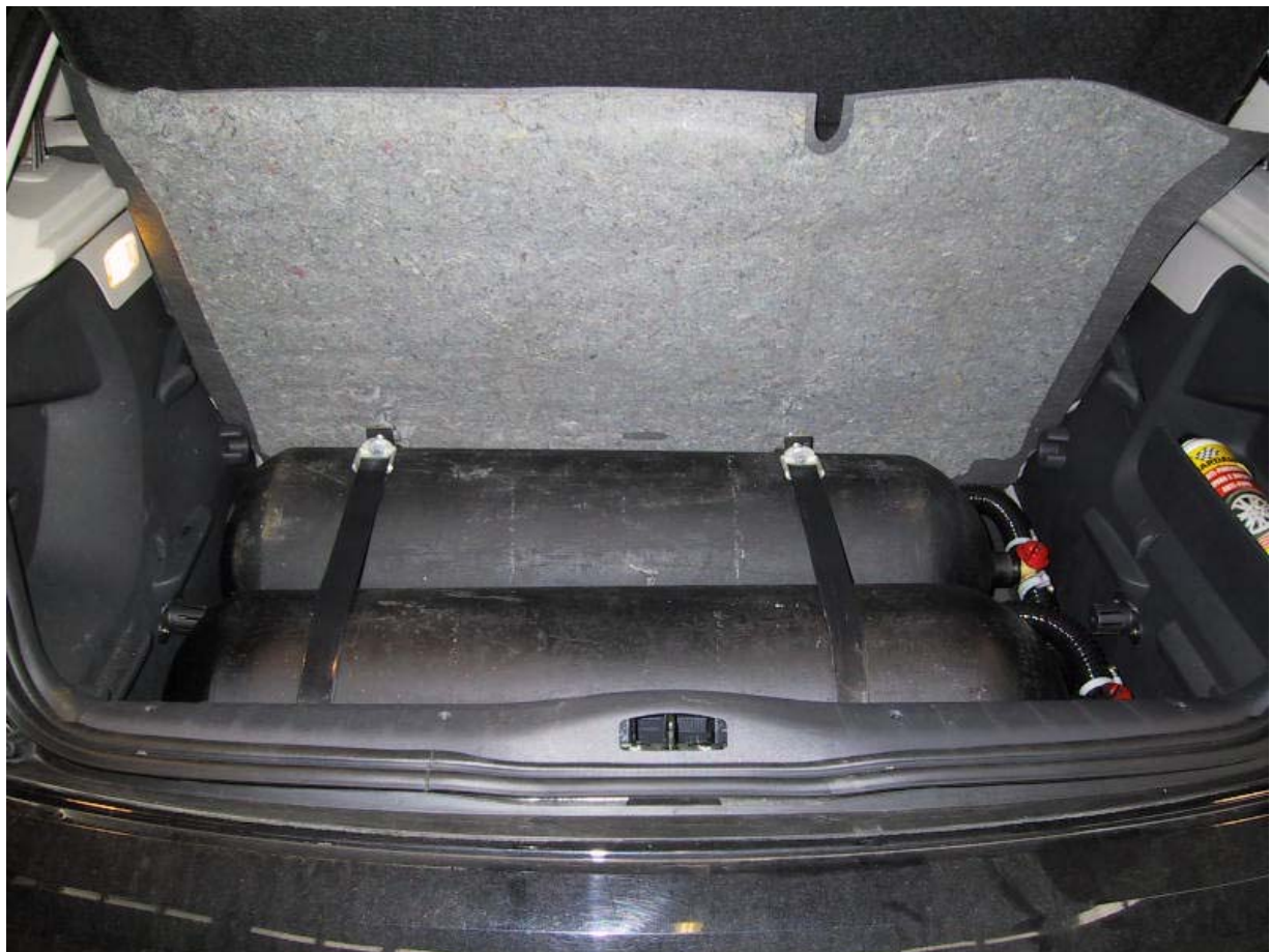
Installazione bombole metano.
