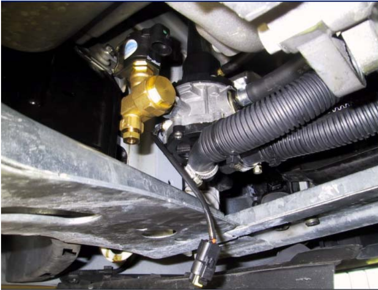
Posizione riduttore di pressione del gas, vano motore lato sx zona inferiore
