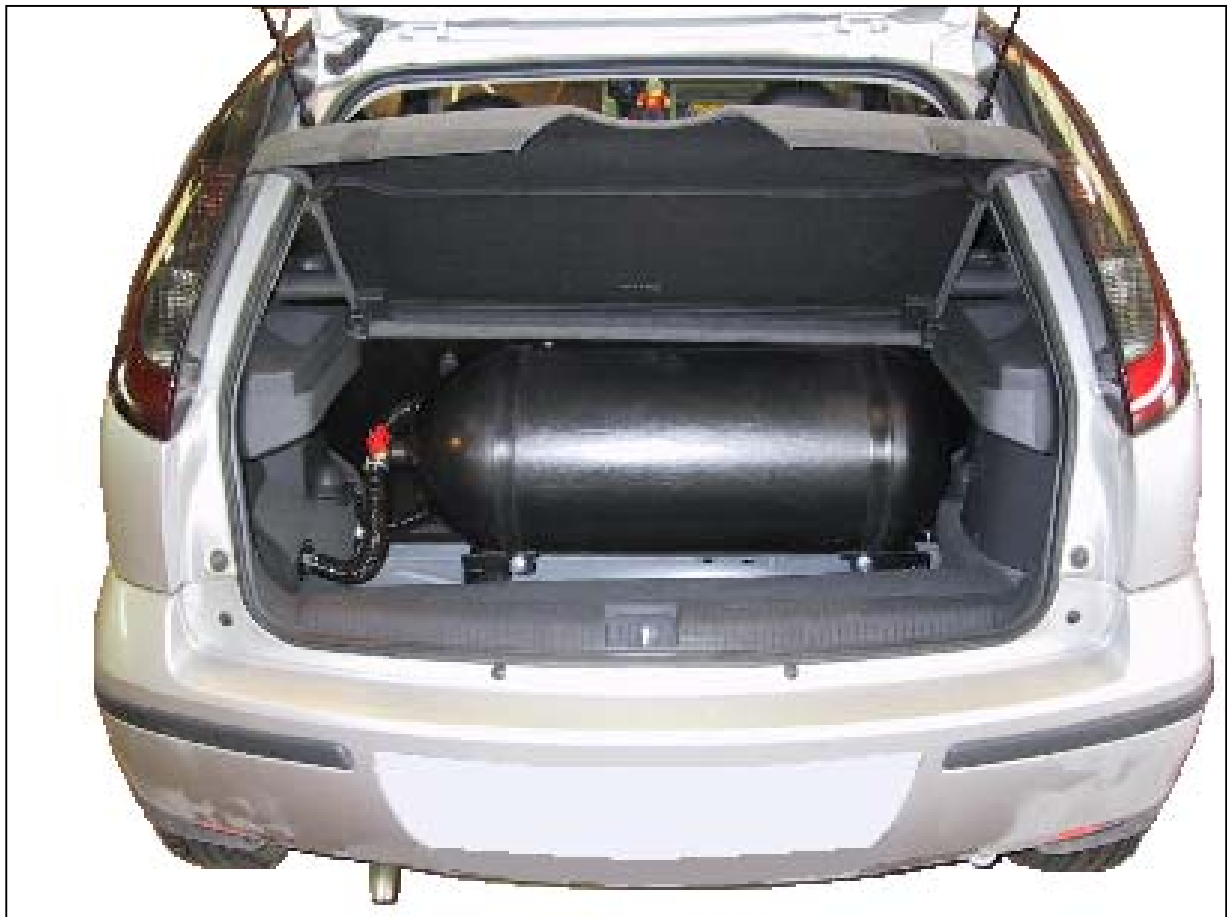
Installazione bombola metano.
