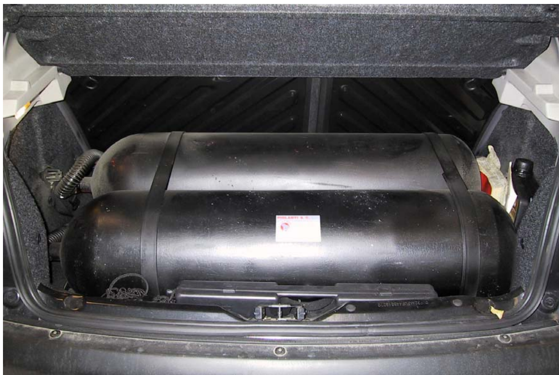
Installazione bombole metano
