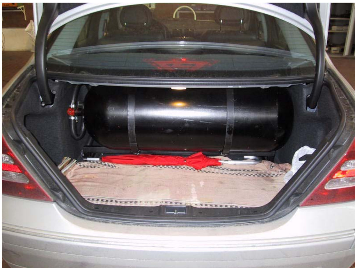
Installazione bombole metano.
