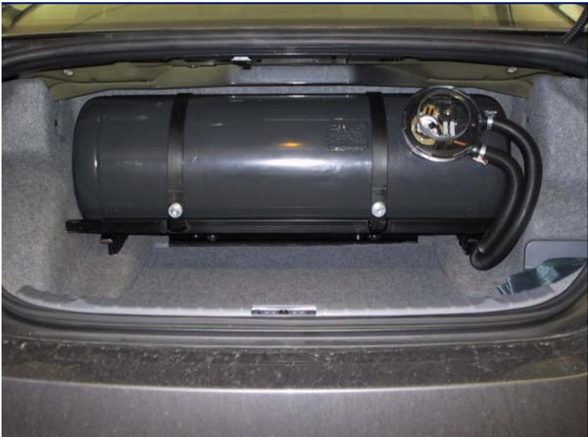
Installazione serbatoio del gas
