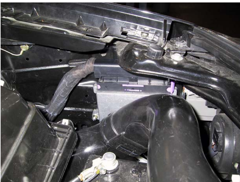
Posizione della centralina del gas
