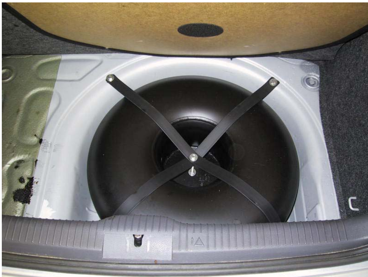
Installazione del serbatoio gpl
