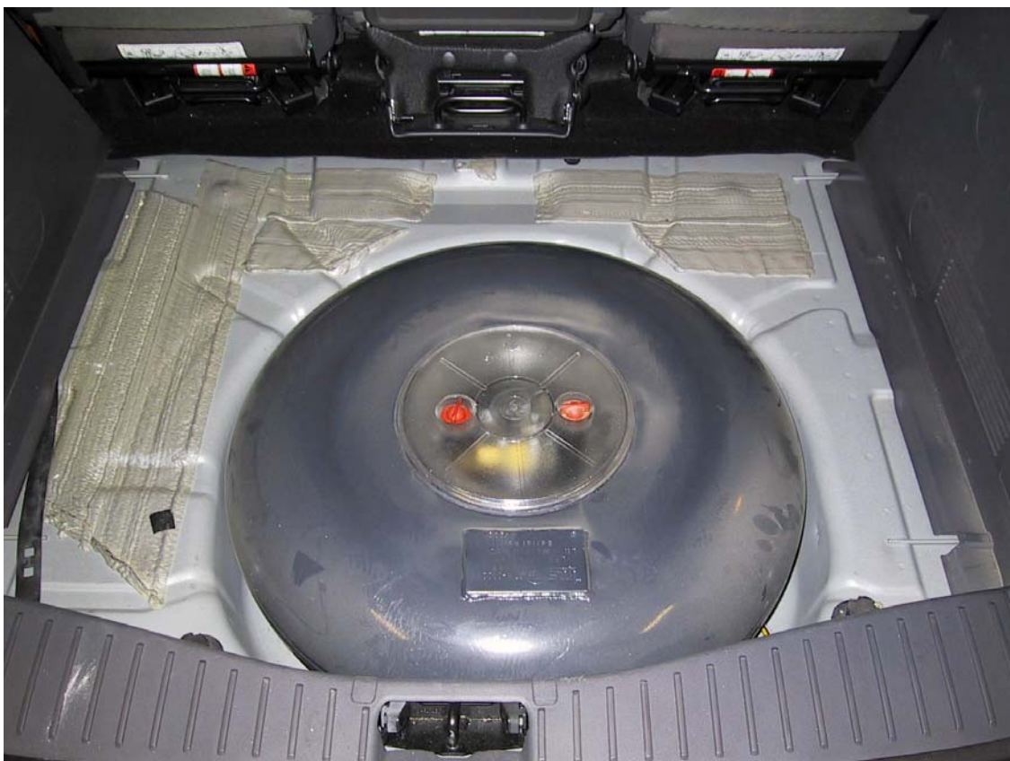
Installazione del serbatoio del gas.
