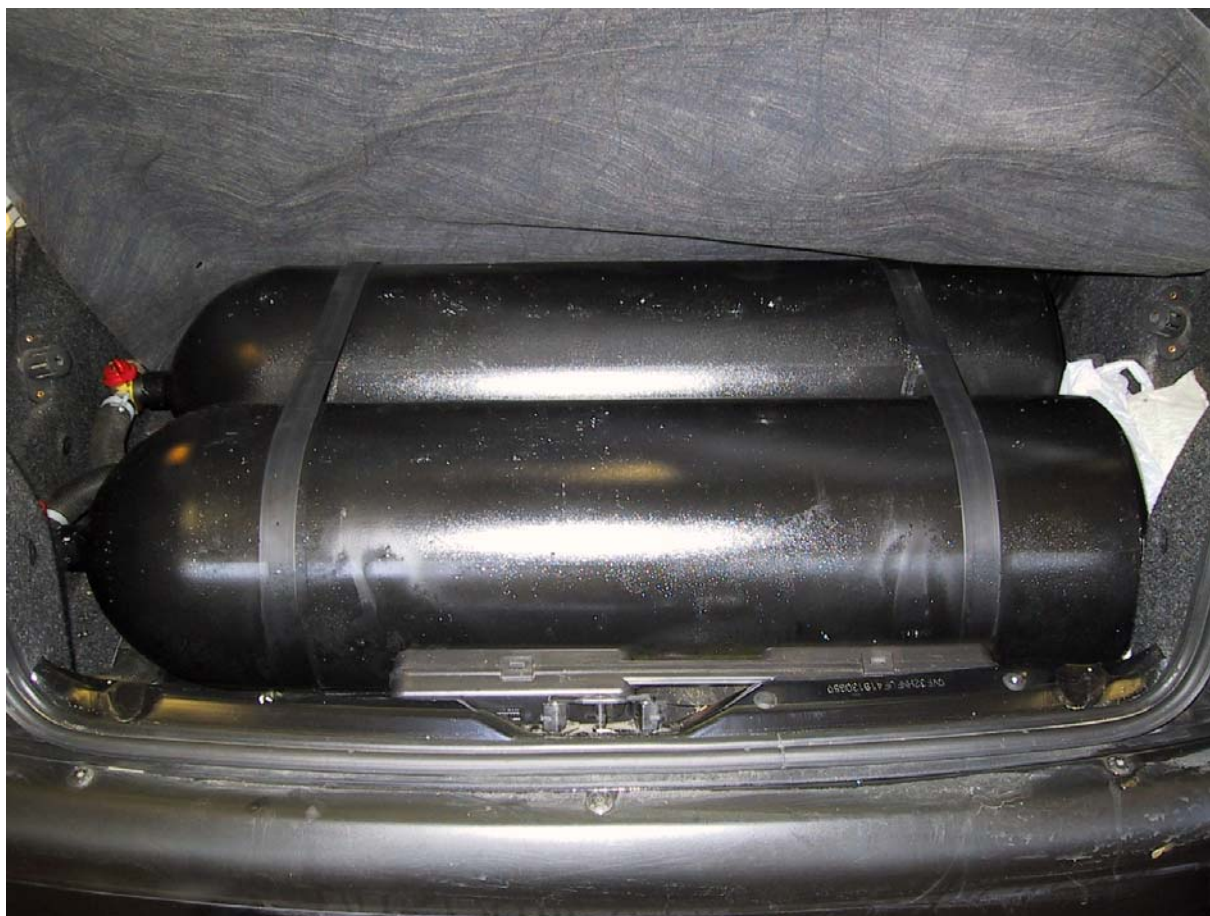
Installazione bombole metano.
