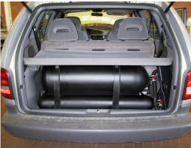
Installazione bombole metano
