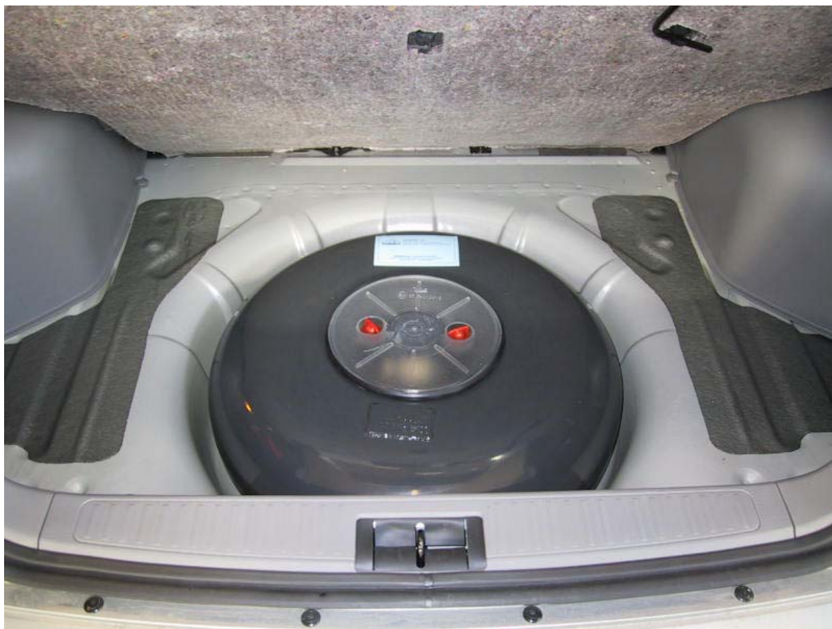
Installazione serbatoio gpl
