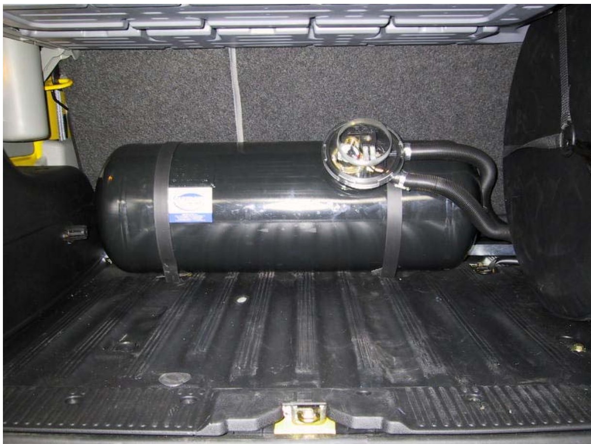
Installazione serbatoio del gas
