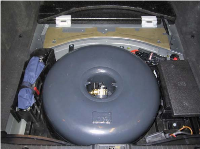
Posizione del serbatoio del gas
