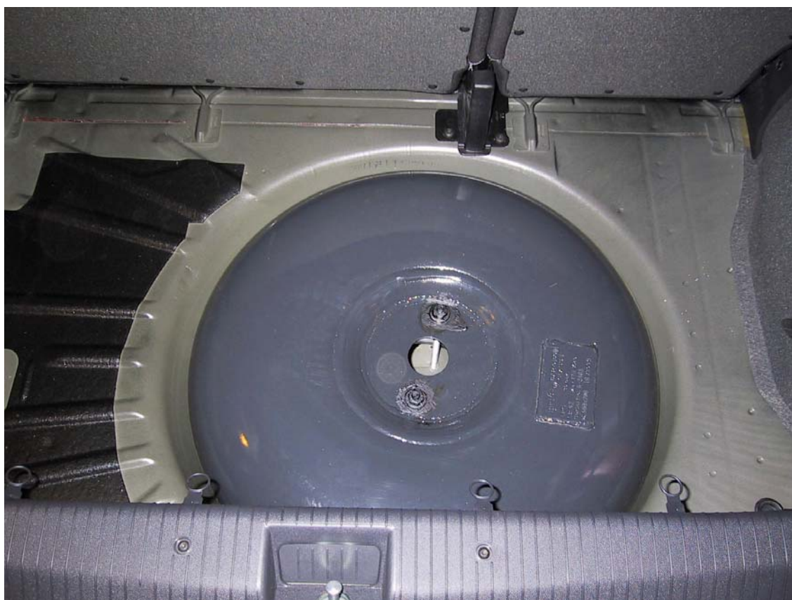
Installazione del serbatoio del gas
