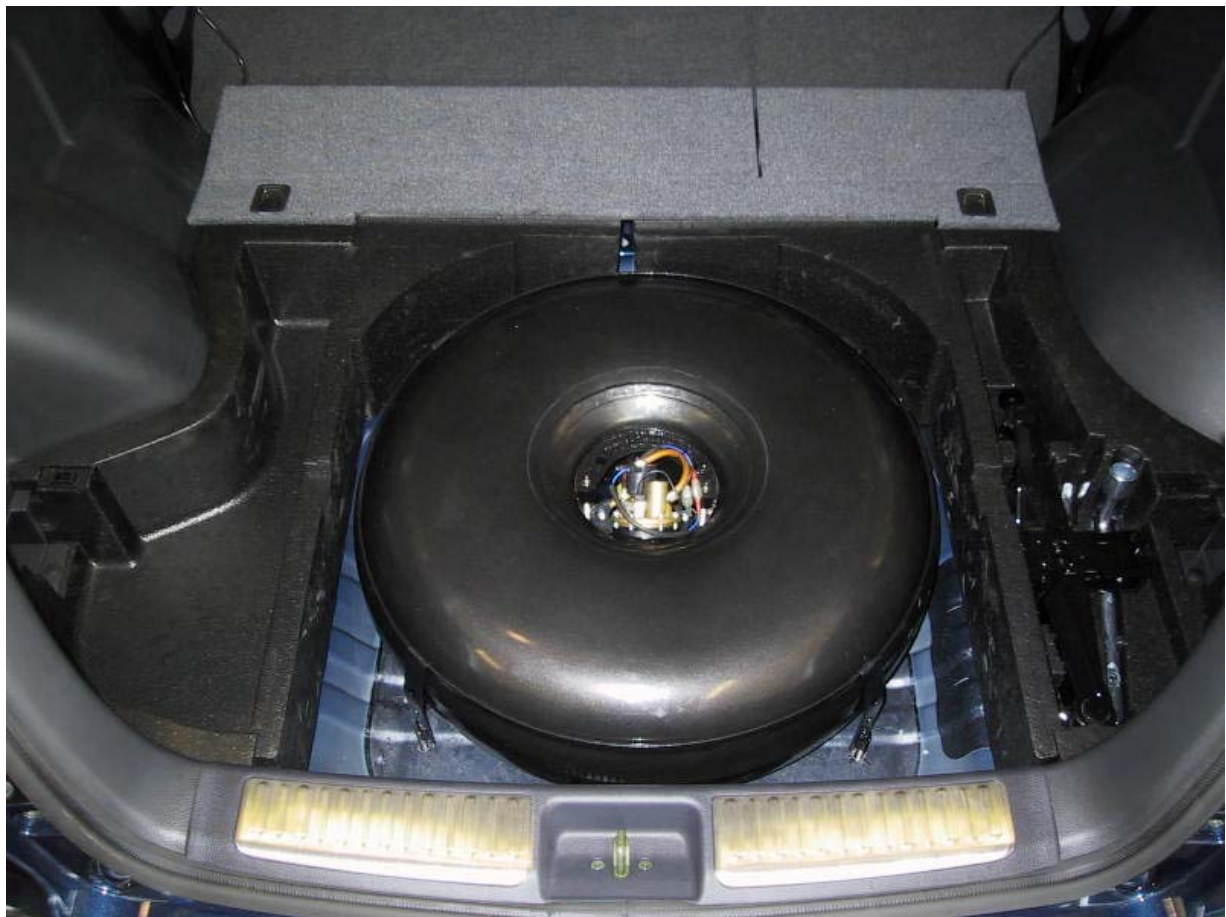
Installazione serbatoio del gas
