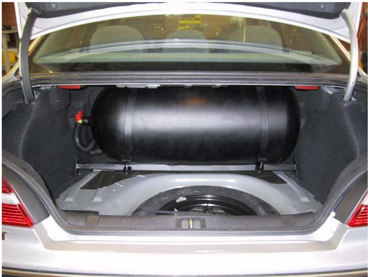
Installazione bombole metano.
