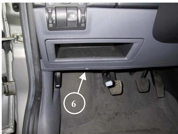
6) Centralina del gas installata sotto il cruscotto.
