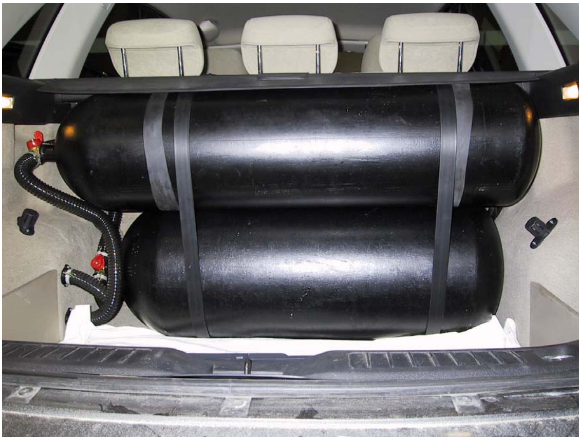
Installazione delle bombole del gas
