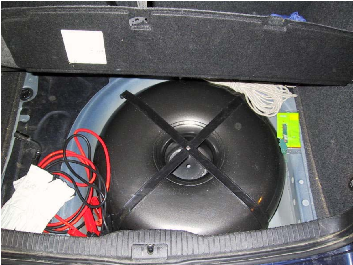
Installazione serbatoio del gas
