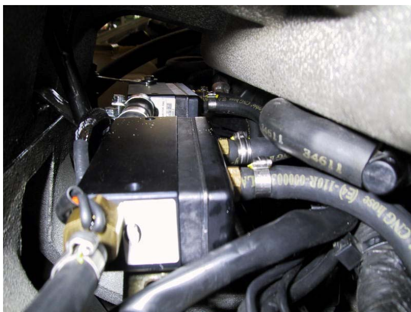
Gruppo iniettori del gas. Di tipo super.
