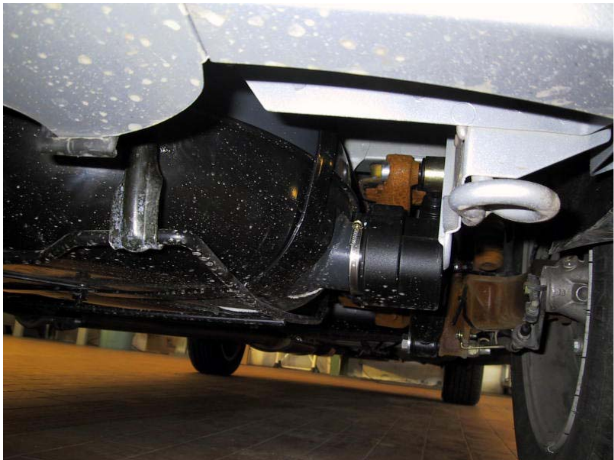
Installazione del serbatoio gpl
