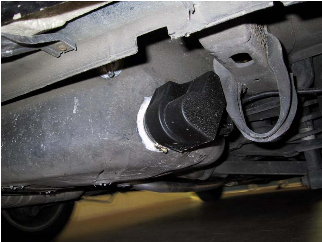
Installazione serbatoio del gas
