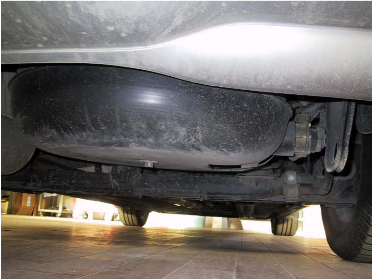
Installazione del serbatoio gpl
