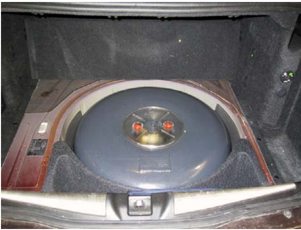
Installazione del serbatoio gpl.
