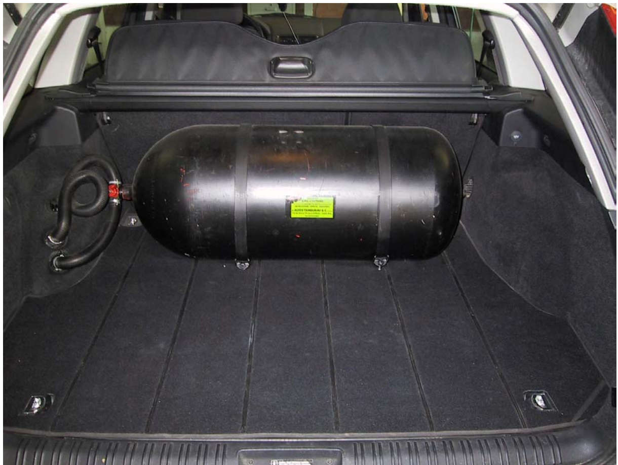
Installazione bombola metano.
