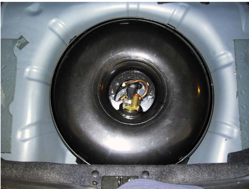
Installazione serbatoio del gas
