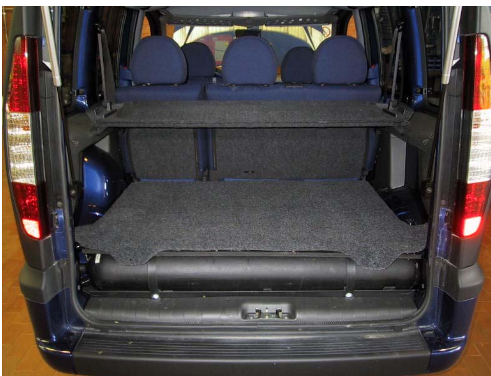
Installazione delle bombole
